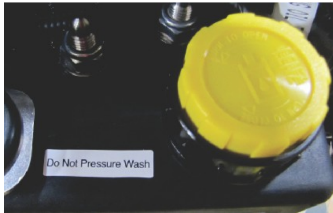
Verschlusskappe des Lenk-/Trimpumpenbehälters
